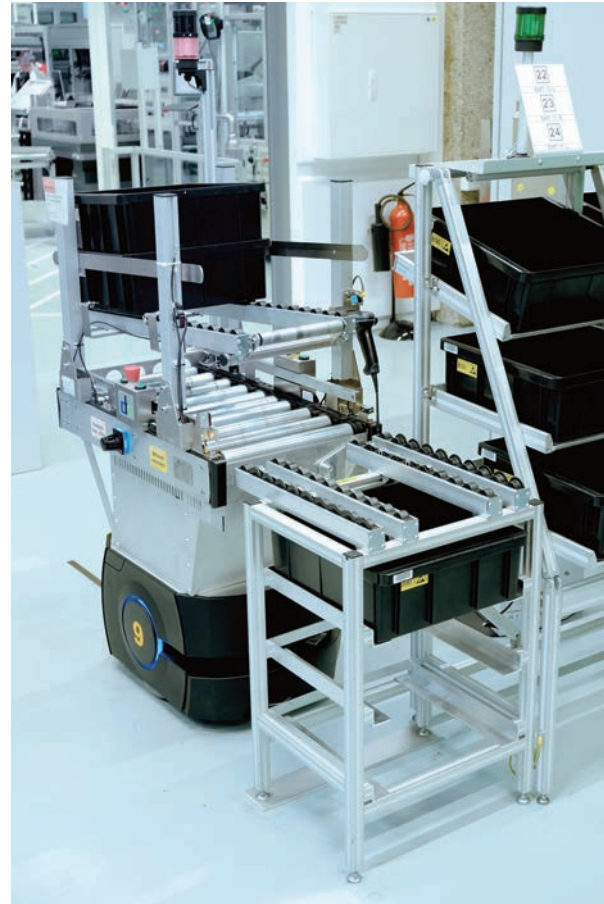
Ein AGV mit Kommissionierboxen: Sowohl die Fahrten des AGV als auch die Position der Boxen werden getrackt.
